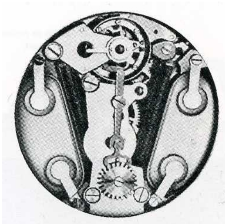
Prototype de 1954 utilisant le piles haricots LIP-Leclanché
